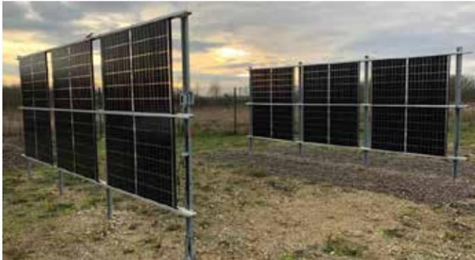
**Abb. 2: Ost/West-Systeme mit den Untergründen Bestandsboden und Mainkies**
