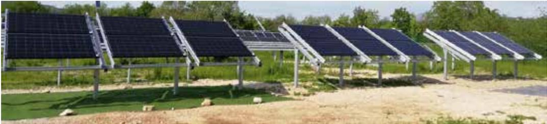
**Abb. 1: Die drei Südsysteme mit den verschiedenen Bodenarten – Von links nach rechts: Kunstrasen, Bestandsboden, Mainkies**
